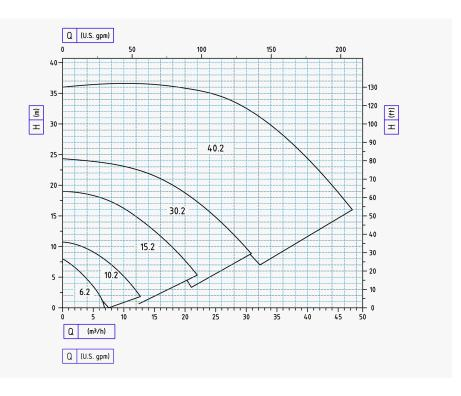
MICRO-CAST CENTRIFUGAL PUMP
